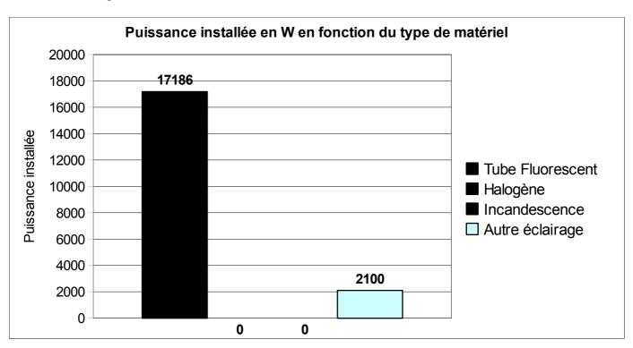
La consommation pour l'éclairage est de 10607 kWh/an Soit une émission de gaz à effet de serre de 849 kg de CO2 par an Si l'éclairage est maîtrisé, cfr il serait possible de faire une économie de 2121 kWh/an soit une émission évitée de 170 kg de CO2/an
