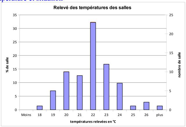
La température moyenne est de 21,93 °C soit 2,93 °C de plus que nécessaire. D'autant que 17 % des fenêtres étaient ouvertes. Si l'on baissait le chauffage, on pourrait espérer une économie de 20,51 % de la consommation d'énergie pour le poste chauffage
